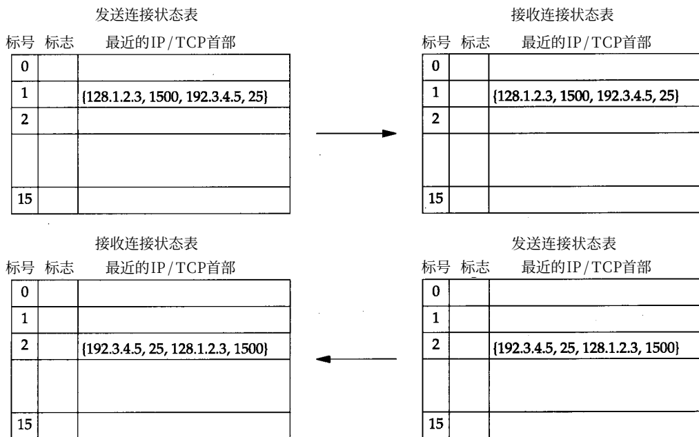
图29-29 链路(如SLIP链路)两端的一组连接状态表
