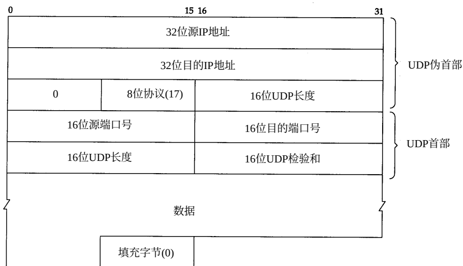
图11-3 UDP检验和计算过程中使用的各个字段
