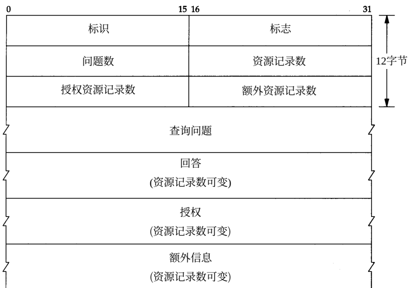
图14-3 DNS查询和响应的一般格式
