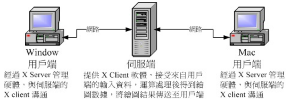
图23.1.2、X Server 用户端的操作系统与 X client 的沟通示意
