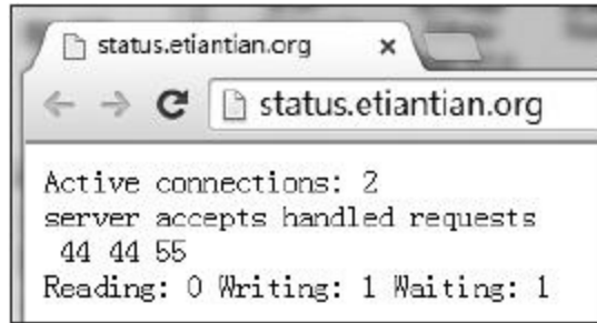
图5-13 查看Nginx状态信息图
