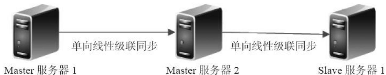
图9-5 线性级联单向双主复制逻辑图
