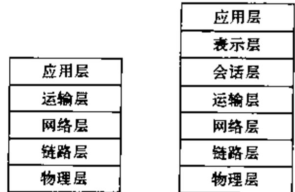
a) 五层因特网协议栈 b) 七层ISO OSI参考模型
