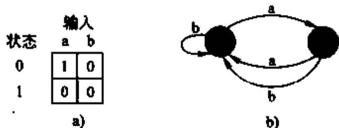
图 32-6 一个简单的两状态自动机, 其状态集 Q = \{0, 1\} , 开始状态 q_0 = 0 , 输入字母表 \Sigma = \{a, b\} . a) 用表格表示的转移函数 \delta . b) 一个等价的状态转换图. 状态 1 是仅有的接受状态(涂黑了). 有向边表示转移. 例如, 从状态 1 到状态 0, 标有 b 的有向边表示 \delta(1, b) = 0 . 此状态机接受那些在最后具有奇数个 a 的字符串. 更准确地说, 一个字符串 x 被接收, 当且仅当 x = yz , 其中 y = \epsilon 或 y 以一个 b 结尾, z = a^k , 其中 k 是奇数. 例如, 对于输入 abaaa , 此状态机的状态序列(包括初始状态)为 \langle 0, 1, 0, 1, 0, 1 \rangle , 因而它接受了这个输入; 对于输入 abbaa , 状态序列是 \langle 0, 1, 0, 0, 1, 0 \rangle , 因而它拒绝了这个输入
