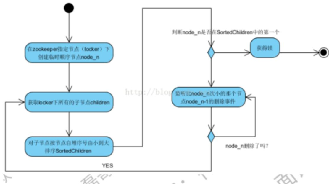
代码的实现主要是基于互斥锁，获取分布式锁的重点逻辑在于 `BaseDistributedLock`，实现了基于 Zookeeper 实现分布式锁的细节。
