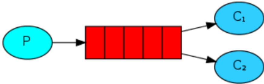
1、消息产生者将消息放入队列消费者可以有多个,消费者 1,消费者 2 同时监听同一个队列,消息被消费。  $C_1 C_2$  共同争抢当前的消息队列内容,谁先拿到谁负责消费消息(隐患:高并发情况下,默认会产生某一个消息被多个消费者共同使用,可以设置一个开关(syncronize) 保证一条消息只能被一个消费者使用)。
