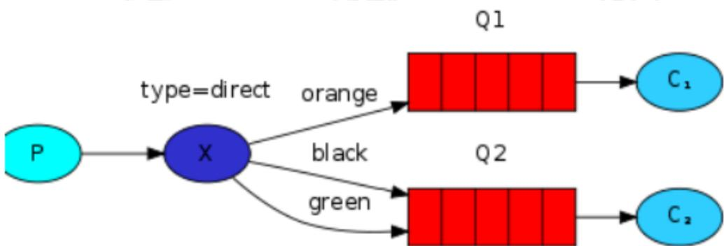
1、消息生产者将消息发送给交换机按照路由判断,路由是字符串(info) 当前产生的消息携带路由字符(对象的方法),交换机根据路由的 key,只能匹配上路由 key 对应的消息队列,对应的消费者才能消费消息;
