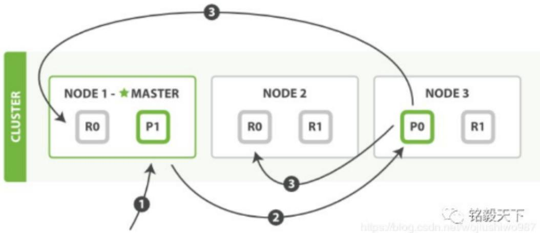
第一步：客户写集群某节点写入数据，发送请求。（如果没有指定路由/协调节点，请求的节点扮演路由节点的角色。）
