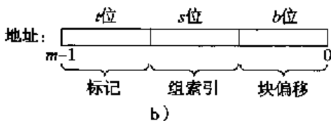
图 6-27 高速缓存 ( S, E, B, m ) 的通用组织。a) 高速缓存是一个高速缓存组的数组，每个组包含一个或多个行，每个行包含一个有效位，一些标记位，以及一个数据块；b) 高速缓存的结构将 m 个地址位划分成了 t 个标记位、 s 个组索引位和 b 个块偏移位
