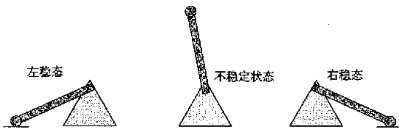
图 6-1 倒转的钟摆。同 SRAM 单元一样，钟摆只有两个稳定的配置或状态
