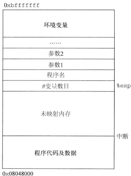
一个Linux程序启动时的内存布局
