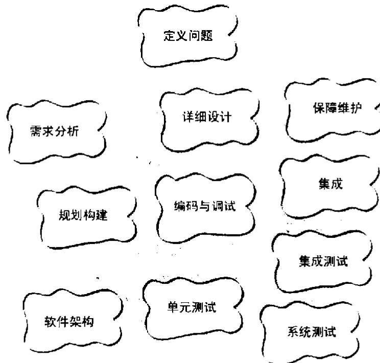
图1-1 构建活动用灰色的椭圆表示。构建活动主要关注于编码与调试，但也包含详细设计、单元测试、集成测试以及其他一些活动
