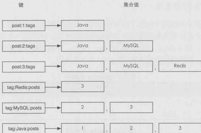
图 3-18 和标签有关部分的存储结构
