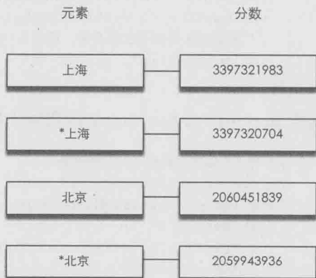
图 5-9 使用有序集合键存储地点和相应 IP 范围的存储结构
