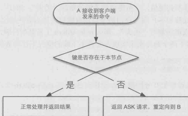
图 8-7 B 的命令处理流程
