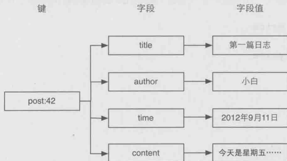
图 3-7 使用一个散列类型键存储一个对象
